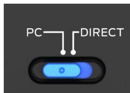
拨动开关在 PC 位置，旋转控制 Line Out 3-4 3.5mm 接口音量，绿色背光灯长亮。按下一次旋钮静音 Line Out 3-4 3.5mm 接口音量，红色背光灯长亮，LCD 屏幕上提示音量图标为 X。长按旋钮可以关闭声卡所有背光和液晶屏幕，保存液晶屏上调试的参数，在关闭状态下旋转该旋钮或耳机音量旋钮激活背光和 LCD 显示屏。
